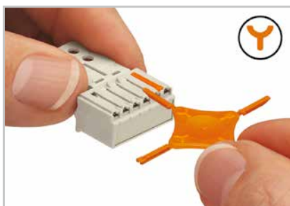
Кодировка розетки (при помощи держателя кодировочного ключа 209х-1610 и двух ключей для розетки, см. символ).
