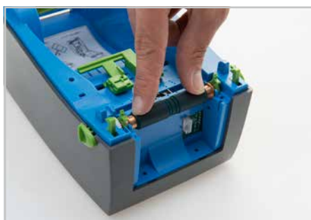
Вставьте и зафиксируйте подходящий валик в принтере.
