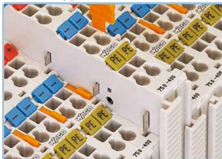
Надёжное автоматическое соединение с помощью луженого самозачищающегося контакта. Заземляющий контакт замыкается первым, а размыкается последним.
