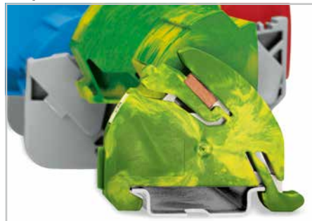
Держатель включает розетку с фиксирующим устройством для шины 10 x 3 мм. Контакт между шиной и рейкой устанавливается автоматически после установки ее на защёлку на несущую рейку. Один конец шины устанавливается на держатель шины с заземлением, второй вставляется в среднюю часть изолированного держателя шины.
