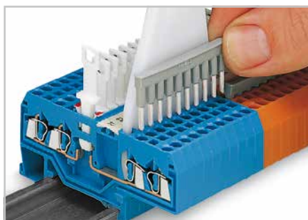
Объединение разъединительных клемм, фронтальный монтаж, при помощи гребешковых перемычек с использованием 10-пол. рабочего инструмента.
