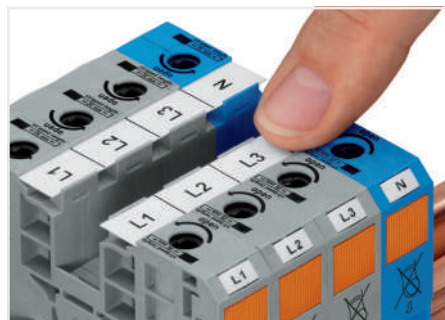
WMB-маркеры или самоклеящиеся, пригодные для печатания маркировочные полоски могут наноситься на силовые клеммы 35, 50 и 95 мм 2 .
