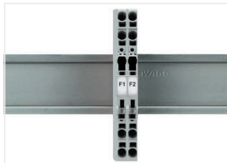
Клеммы с предохранителем шириной 6,2 мм могут устанавливаться рядом друг с другом. В конце монтажа при отсутствии смежной клеммы с предохранителем необходимо использовать торцевую пластину.
