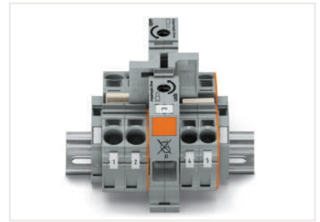
Объединение клемм 35 мм 2 (2 AWG) POWER CAGE CLAMP с клеммами 10/16 мм 2 (8/6 AWG) серий 2010 и 2016 TOPJOB® S с использованием переходных перемычек (не подходит для 2016-76xx и 2016-77xx).
