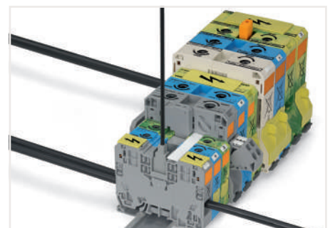
Всегда утапливайте отвод потенциала (283-407) в клемму до упора!
