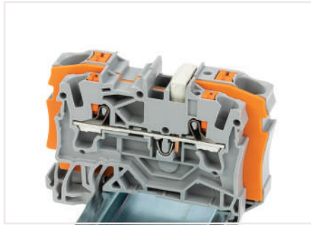
Переходная перемычка (2006-499) объединяет клеммы 6/4 мм 2 (10/12 AWG; серии 2206/2204) с клеммами 4/2,5/1,5 мм 2 (12/14/16 AWG; серии 2204/2202/2201).
