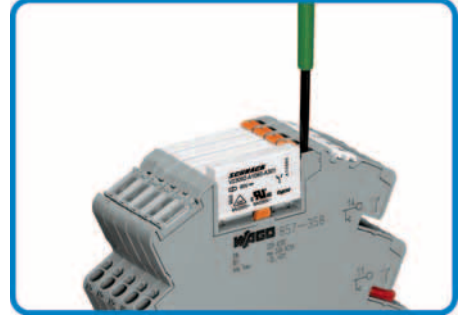
Работа выталкивателя реле
