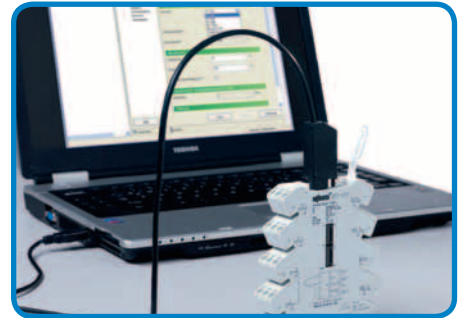
Конфигурирование переключателей с абонентским кабелем WAGO-USB 750-923
