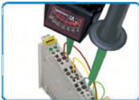
Проверка прохождения сигнала при подсоединенных проводниках
