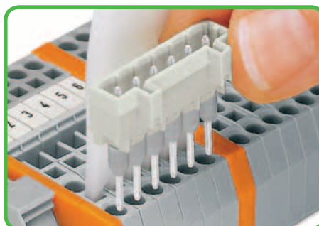
Рабочий инструмент, используемый с клеммами серии 280, монтируемыми на DIN-рейку: для вставки вилок и розеток с длинными контактными выводами в клеммы серии 280 (максимальное кол-во полюсов для монтажа в производственных условиях - 10).
