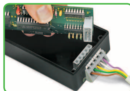
Угловая розетка, используемая как соединитель для сквозного монтажа. Порты и рабочие разъемы для монтажа расположены вне корпуса. Толщина панели до 2 мм/0,079 дюйма. На рисунке изображен шаг контактов 5 мм/0,197 дюйма.
