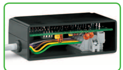
Угловая розетка, установленная внутри корпуса. Вилка с прямыми выводами под пайку используется для горизонтального монтажа на печатных платах в узких корпусах.
