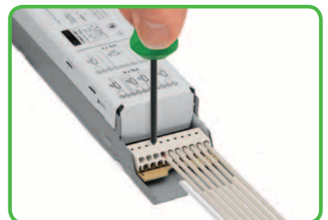
Извлечение проводника при помощи инструмента для демонтажа Ø 1,0 мм
