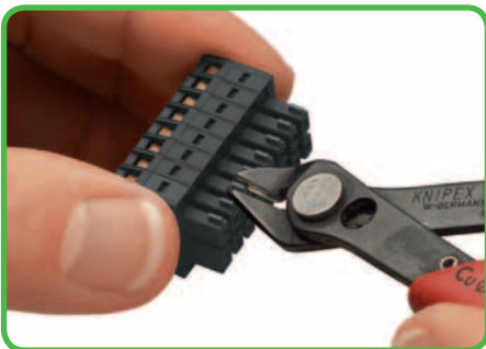
Кодирование розетки посредством извлечения кодировочных штифтов.
