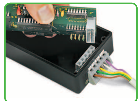
Угловая розетка используется как соединитель для сквозного монтажа. Вход проводника и монтажные отверстия вне корпуса. Толщина панели до 2 мм/0,079 дюйма.
