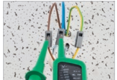
Измерение через отдельное тестовое гнездо.
