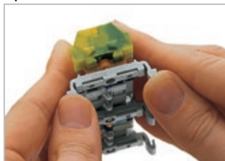
Клеммная колодка с опорными ножками, подключение к монтажному адаптеру 209-123 (расстояние между адаптерами не должно превышать 35 ... 40 мм).
