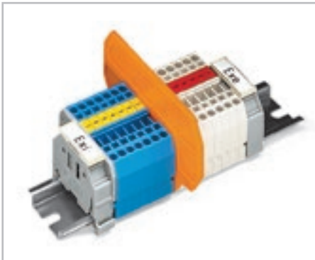
Разделительная перегородка для применений с уровнями взрывозащиты Ex e / Ex i Согласно EN 50020, между находящимися под напряжением деталями цепей Ex e и Ex i должна соблюдаться дистанция в 50 мм. Использование разделителей Ex e / Ex i позволяет сэкономить место, когда клеммы Ex e и Ex i монтируются на обычную несущую рейку. Подходит для клеммы серии 279 ... 282. 209-190 для 2-проводных клемм 209-191 для 2-, 3-, 4-проводных клемм.
