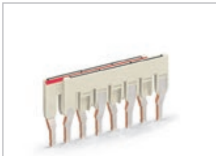
Перемычки, установленные в шлицы Это позволяет изготавливать специализированные перемычки «через один», напр., для соединения клемм с различным потенциалом. Убедитесь, что только один лепесток контакта соприкасается с клеммой.
