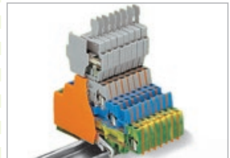
При использовании трехуровневых клемм вместе со штекерами с предохранителями (ширина 6 мм) на уровне розетки (верхний), превышенная длина может быть компенсирована для серии 280 (ширина 5 мм) с помощью промежуточной пластины (толщиной 1,1 мм).
