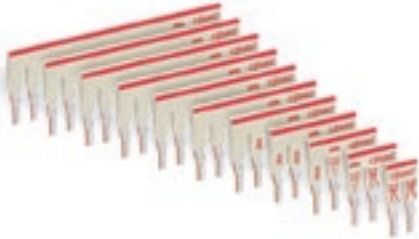
Перемычка «через один» на 7 контактов Отлом контактных лепестков – отдельные контакты перемычки могут быть отделены путем излома. Оставшаяся часть изоляции будет соответствовать требованиям по размеру зазора и пути утечки тока.
