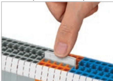
Перемычку всегда вставляйте до упора! При использовании многополюсных перемычек установку производят поочередно с каждой стороны.
