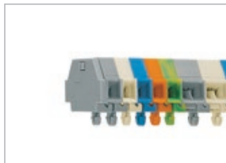
Клеммная колодка с опорными ножками, для панелей толщиной 0,6 мм ... 1,2 мм, крепежное отверстие Ø 3,5 мм (устанавливается на алюминиевую рейку 210-154 или на DIN-рейку 35 мм с монтажным адаптером 209-120)
