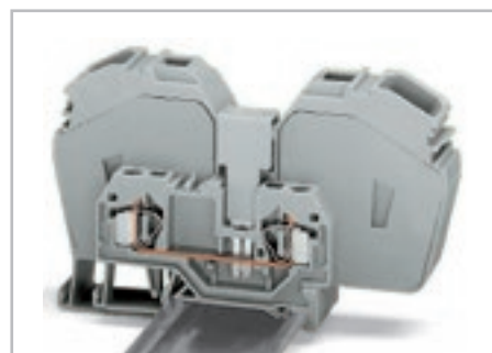
Переходная перемычка 283-414 может также объединять проходные клеммы 35 мм 2 (AWG 2) 285-635 с проходными клеммами 4 мм 2 (AWG 12) 281-901 . Сведения о проходных клеммах 35 мм 2 /AWG 12, см. на стр. 194.
