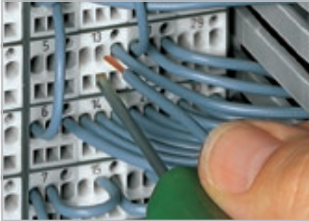
Подключение проводника с помощью рабочего инструмента 210-279 (2,5 x 0,4) мм.
