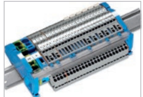
Дополнительная прозрачная крышка распределительной шины (777-303) предохраняет шину от непреднамеренного контакта и позволяет легко проверить подключенные к шине клеммы.
