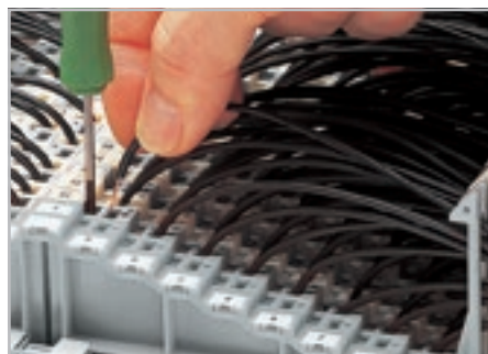
Заделка и удаление проводников с помощью рабочего инструмента (2,5 x 0,4) мм.
