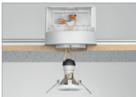
Индивидуальная конструкция низковольтных систем освещения
